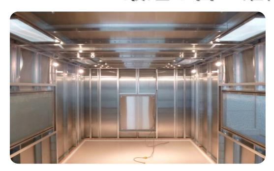
工期 1 日~で、すぐに電磁波簡易測定スペースを確保できます。 光が入る天井・側面パネルで、空気の流れもあるため、 室内灯やエアコンは不要です。 従来のパネル式シールドルームと比べ、軽量で簡単に施工できます。
